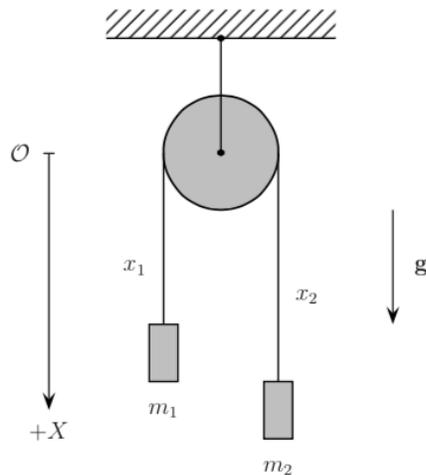
Figura 2: A máquina de Atwood via mecânica lagrangiana.
