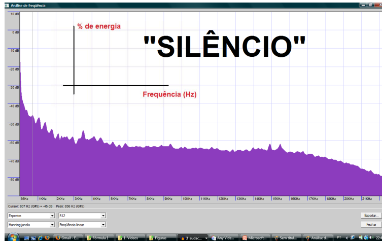
Figura D.1 Análise espectral do ruído de fundo de uma sala.
