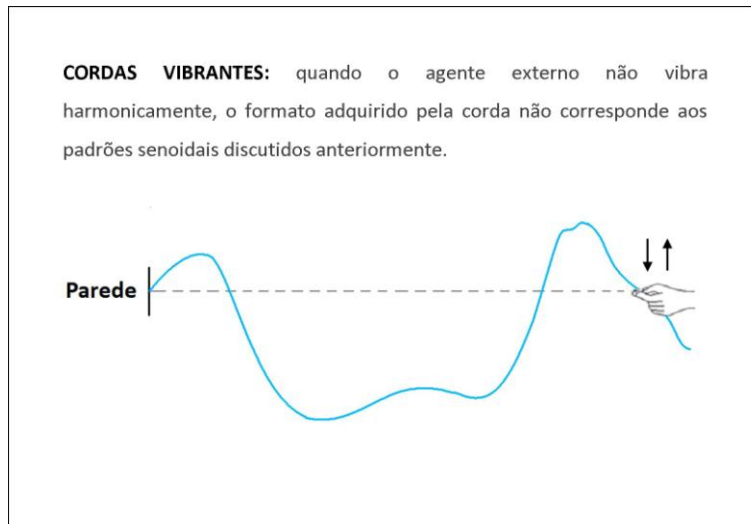
Figura II.6 Formato irregular adquirido pela corda quando o agente externo (a mão) não executa um movimento harmônico.
