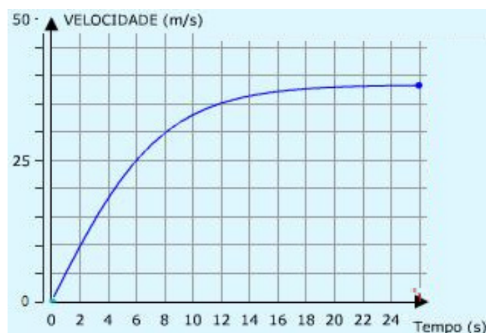
Figura 7 - Gráfico com dados simulados da velocidade em função do tempo de um corpo em queda em meio viscoso.
