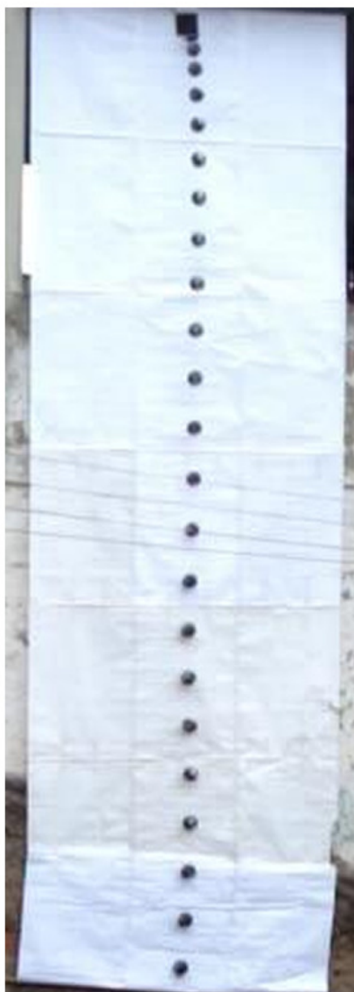
Fotografia estroboscópica digital de uma esfera de isopor em queda no ar
