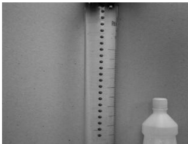
Figura 27 - Fotografia estroboscópica de uma esfera caindo através da glicerina.
