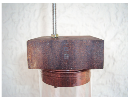
Figura 22(b) – Detalhe da tampa de lançamento das esferas. Esse recurso foi importante para se obter trajetórias retilíneas e centralizadas facilitando a reprodutibilidade dos lançamentos.
