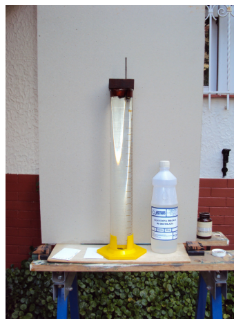
Figura 22(a) - Sistema experimental para queda de esferas em diferentes meios fluidos.
