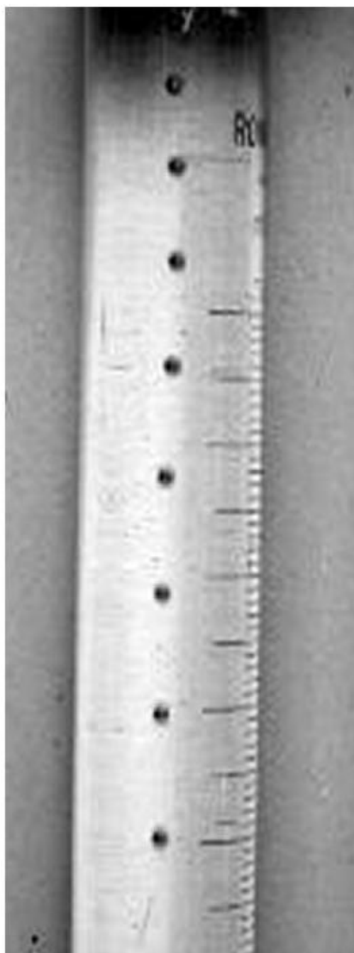
Fotografia estroboscópica de uma esfera de aço em queda na água
