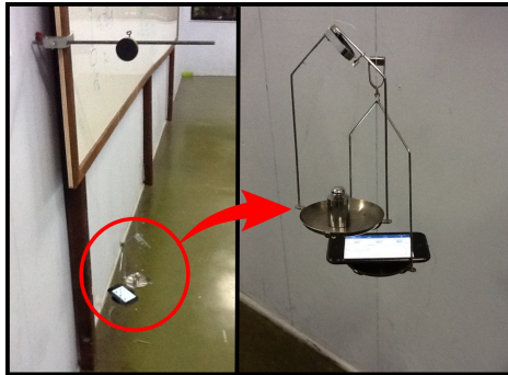
Figura A.23: Montagem da máquina de Atwood feita em sala de aula.
