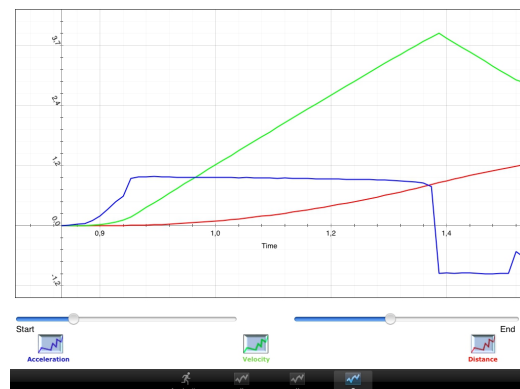
Figura 3.5: Tela de gráficos do Acceleration , mostrando a aceleração, velocidade e posição em uma queda livre.
