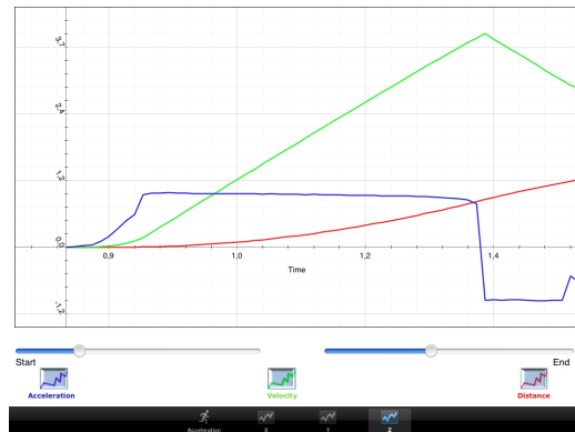
Figura A.3: Tela de gráficos do Acceleration , mostrando a aceleração, velocidade e posição em uma queda livre.
