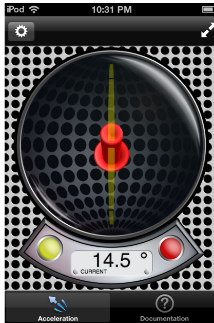
Figura A.19: Medida do ângulo com o Accelmeter colocado sobre a mesa inclinada.
