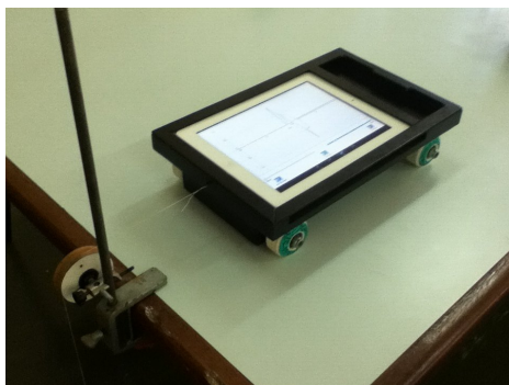
Figura 3.29: O iCar preso a uma massa com auxílio de uma roldana.
