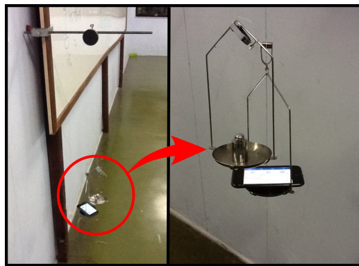
Figura 3.27: Montagem da máquina de Atwood feita em sala de aula.
