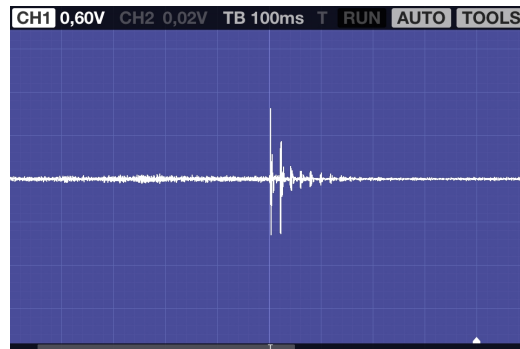
Figura C.3: O som da batida com a mão na extremidade de um tubo, gravado por um smartphone . Os pulsos sucessivos ao primeiro são “ecos” que saem do tubo após múltiplas reflexões nas extremidades abertas.
