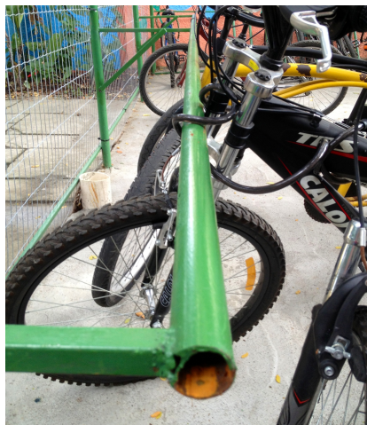
Figura 6.4: Tubo usado na medida da velocidade do som: o bicicletário da escola.
