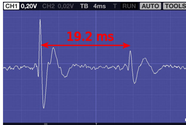
Figura C.5: Dois sinais sucessivos gravados numa extremidade do tubo e o tempo entre eles.
