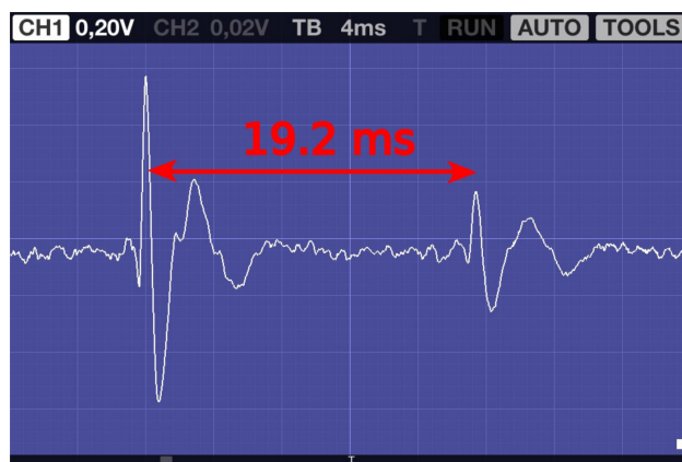
Figura 6.5: Dois sinais sucessivos gravados numa extremidade do tubo e o tempo entre eles.
