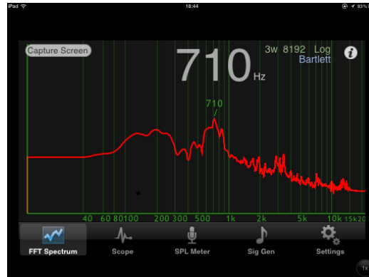
Figura 6.8: Imagem de uma tela do aplicativo em funcionamento, mostrando o pico de frequência.
