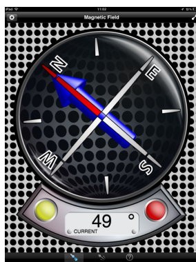
Figura 4.1: Tela do aplicativo MagnetMeter . A direção do campo magnético é dada pela seta em 3D que é vista sob o ponteiro da bússola. O número na parte de baixo da janela é a intensidade do campo magnético em \mu\text{T} .
