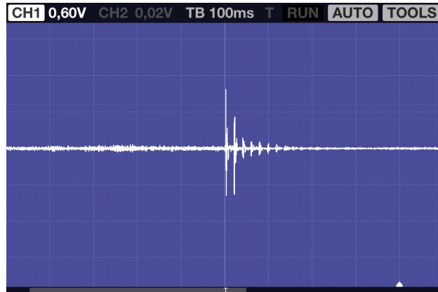
Figura 6.3: O som da batida com a mão na extremidade de um tubo, gravado por um smartphone . Os pulsos sucessivos ao primeiro são “ecos” que saem do tubo após múltiplas reflexões nas extremidades abertas.
