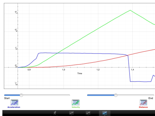
Figura 3: Tela de gráficos do Acceleration , mostrando a aceleração, velocidade e posição em uma queda livre.
