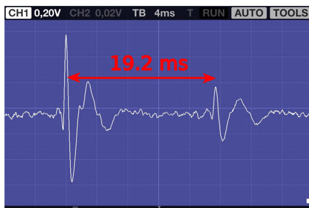
Figura 5: Dois sinais sucessivos gravados numa extremidade do tubo e o tempo entre eles.
