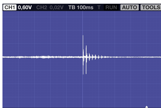
Figura 3: O som da batida com a mão na extremidade de um tubo, gravado por um smartphone . Os pulsos sucessivos ao primeiro são “ecos” que saem do tubo após múltiplas reflexões nas extremidades abertas.
