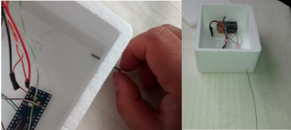
Figura 89: Furo no recipiente para a passagem da antena.
