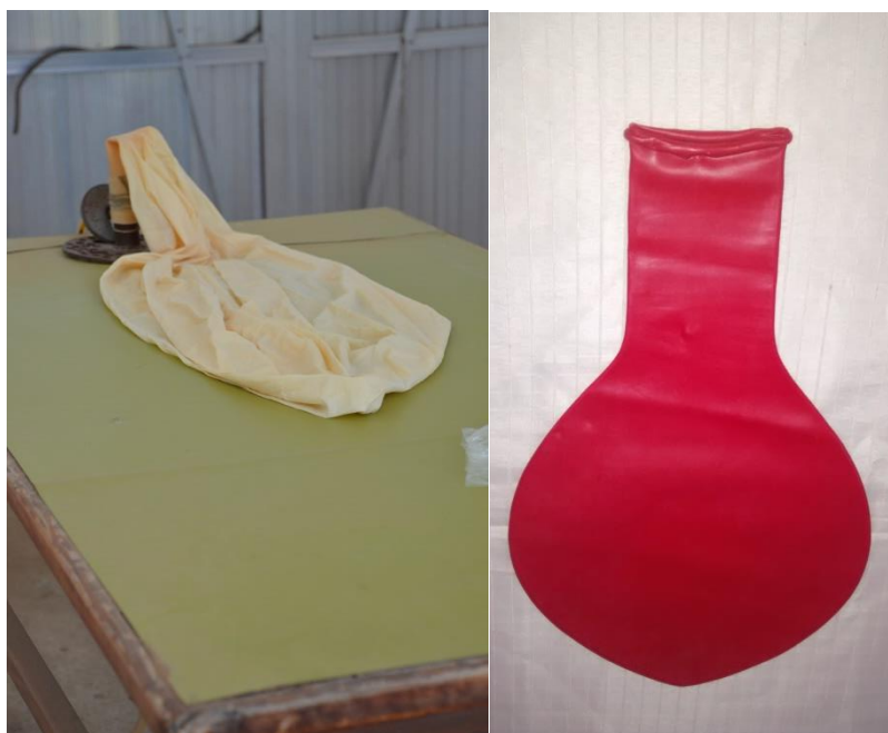
Figura 100: Balão meteorológico. À esquerda balão utilizado na estação do Galeão, à direita o balão de festas (nº350), utilizado neste projeto.
