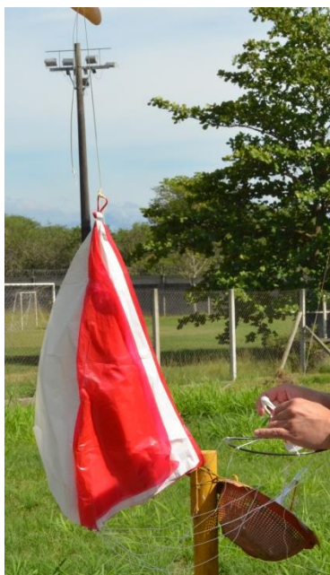
Figura 102: Paraquedas utilizado para a segurança na descida da radiossonda.
