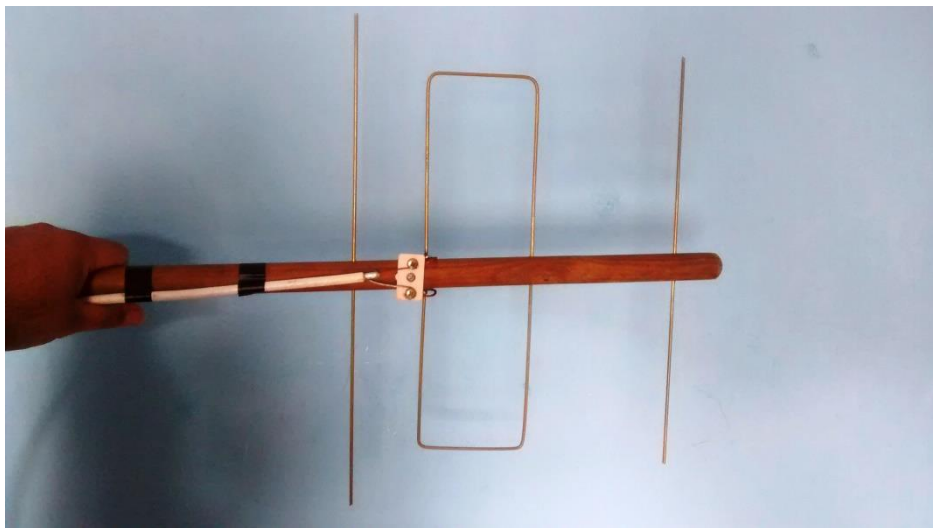
Figura 37: Antena Yagi LFA para a frequência 403 MHz.
