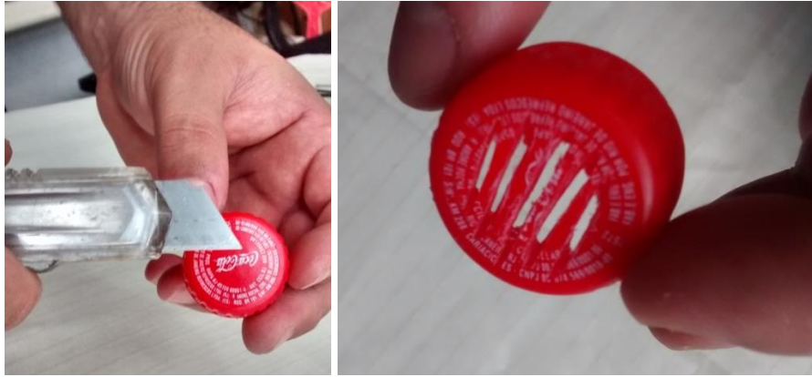
Figura 87: Construindo um abrigo contra radiação solar para o sensor BMP180.
