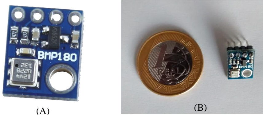
Figura 24: (A) Sensor BMP 180 para a medição de pressão e temperatura. (B) Comparação do sensor BMP180 com uma moeda de um real.
