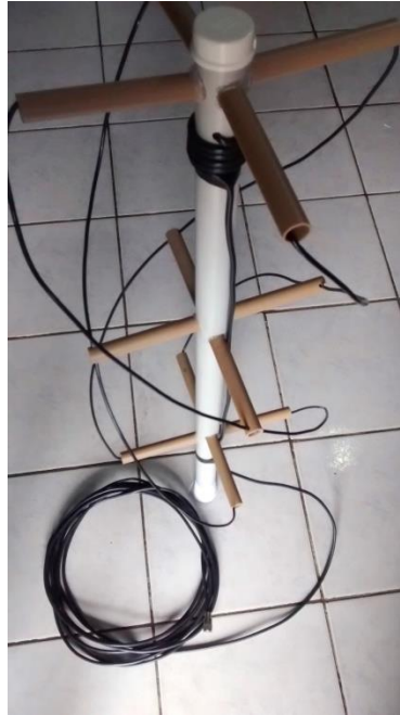
Figura 59: Antena QFH utilizada no projeto para receber imagens do satélite NOAA.
