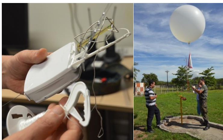
Figura 78: Radiossonda RS92-SGP utilizada na EMA-GL (Estação Meteorológica de Altitude do Galeão).
