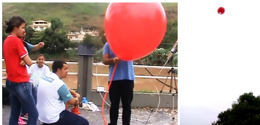
Figura 77: Balão usado no transporte da radiossonda sendo preenchido com gás Hélio e, à direita o balão sendo lançado.
