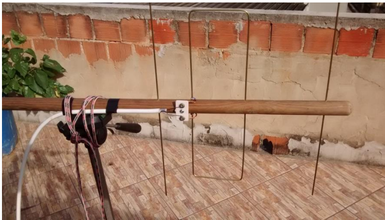
Figura 62: Antena posicionada para captar o sinal da radiossonda. A antena foi fixada em um tripé de câmera fotográfica.
