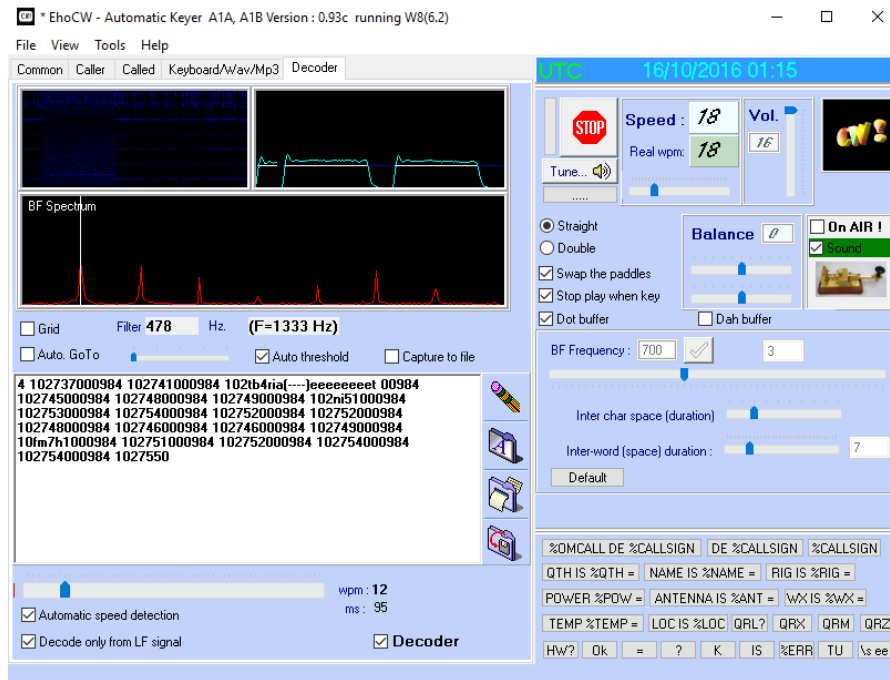
Figura 98: EhoCW decodificando os dados da radiossonda
