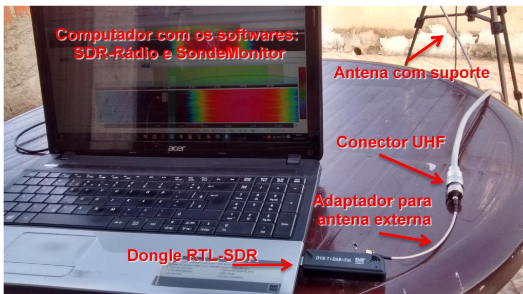
Figura 63: Equipamento conectado para captar o sinal da radiossonda.
