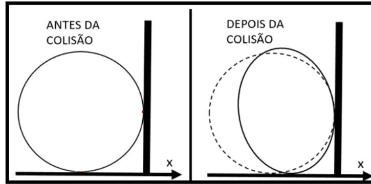
A partir do fenômeno reproduzido, encontre uma expressão para medir a força média de impacto entre a bola e a parede sabendo que durante a colisão o centro de massa se deslocou  $d_{cm}$ . Explique também, usando a 1ª Lei da Termodinâmica, o que aconteceu com a energia cinética que a bola possuía.
