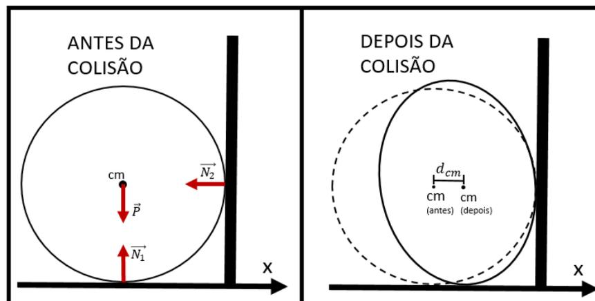
Observe que a partir do diagrama de forças temos que  $\vec{P}$  e  $\vec{N}_1$  se anulam e que a força resultante no sistema durante o intervalo de tempo que dura a colisão corresponde a  $\vec{N}_2$  ( $F_r = N_2$ ). Note que durante o choque o ponto de aplicação da força  $\vec{N}_2$  não realiza deslocamento e como consequência não realiza trabalho.
