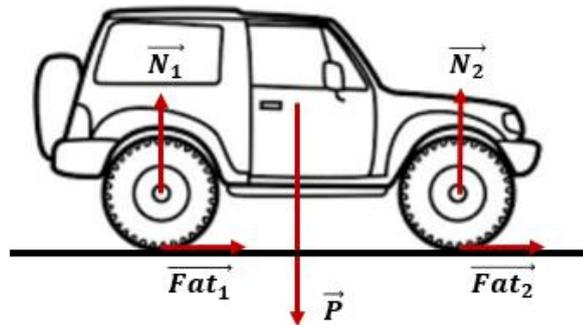
Como segundo passo na direção de solucionar o problema, note que ao aplicarmos a 2ª Lei de Newton encontraremos que a força resultante do sistema terá intensidade  $F_r = 2F_{at_1} + 2F_{at_2}$  mas que as forças de atrito  $\vec{F}_{at_1}$  e  $\vec{F}_{at_2}$  não realizam trabalhos uma vez que o ponto de aplicação das forças não é deslocado (se não ocorrer derrapagens).
