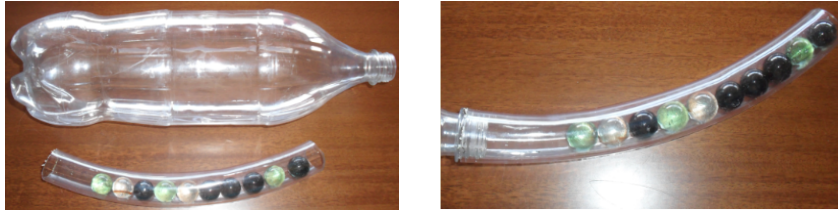
Figura 3.11: Material e montagem de experimento com garrada PET, mangueira e bolinhas de gude [28].
