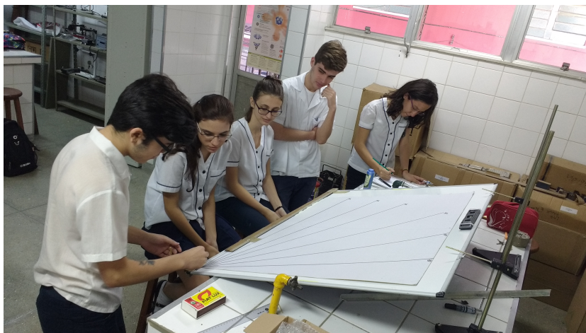
Figura 3.8: Grupo de estudantes realizando o experimento na 3ª aula. Enquanto um manuseia o lançador, outros observam para marcar o ponto de interseção com a reta inclinada (desenhada sobre a cartolina). Ao fundo, uma aluna anota os dados.
