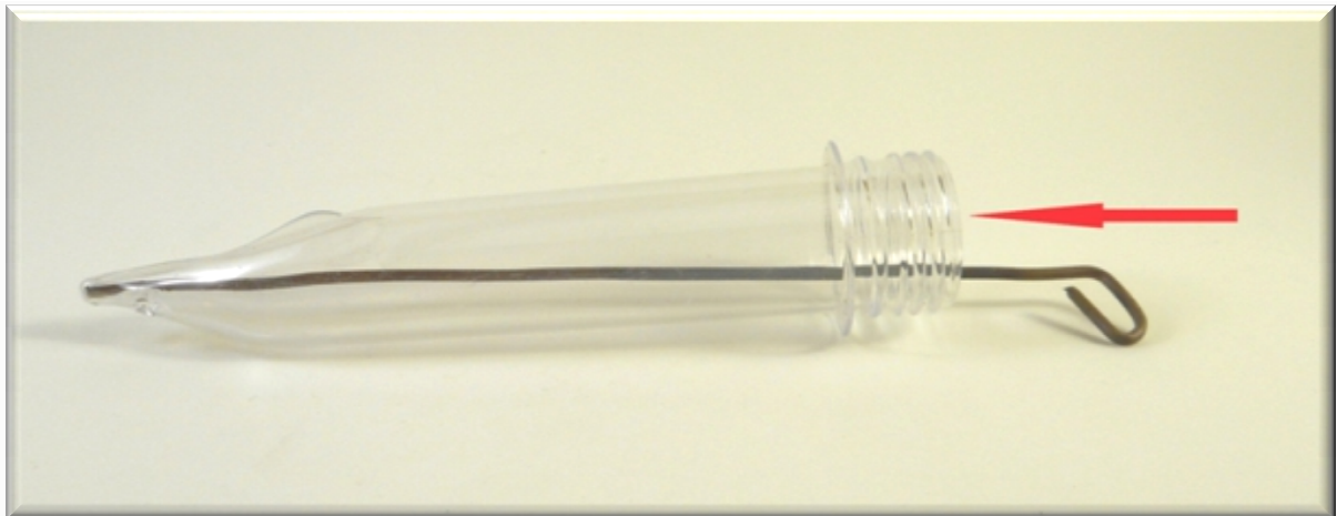
Figura 24 - Preparação do tubo de ensaio para conexão da mangueira
