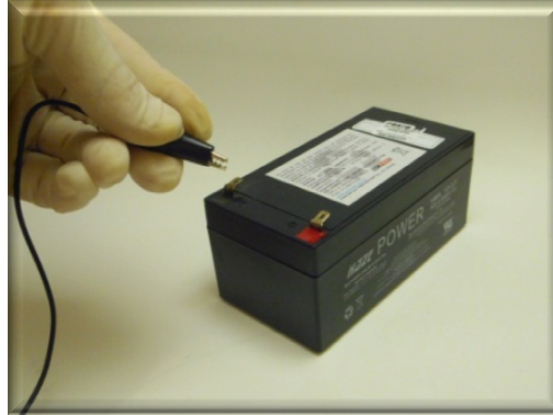
Figura 37 - Preparação da bateria, terminal negativo
