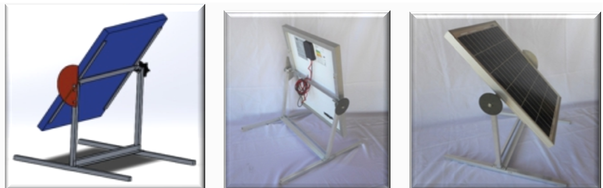
Figura 16 - Estrutura de alumínio desenvolvida de acordo com o projeto
