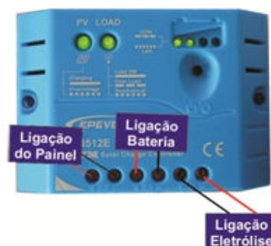
Figura 33 - Posição para ligação dos cabos elétricos no controlador
