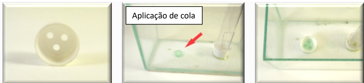
Figura 29 - Fixação da tampa no aquário
