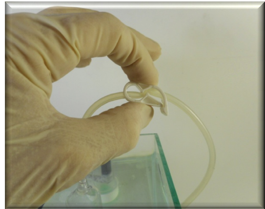
Figura 49 - Fechamento do estrangulador para armazenamento do hidrogênio
