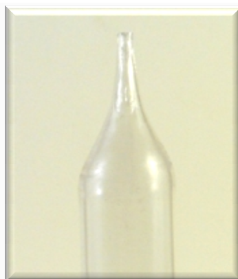
Figura 25 - Extremidade do tubo após preparação
