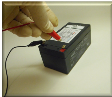
Figura 38 - Preparação da bateria, terminal positivo
