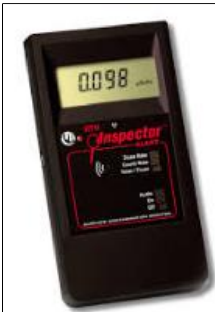
Figura 68-Imagem do modelo de contador Geiger utilizado durante a atividade aplicada.
