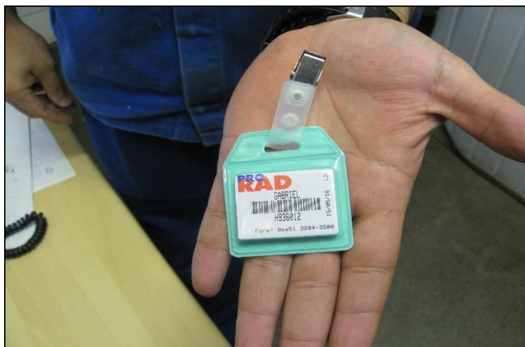
Figura 46-Dosímetro utilizado pelo funcionário da NUCLEP.
