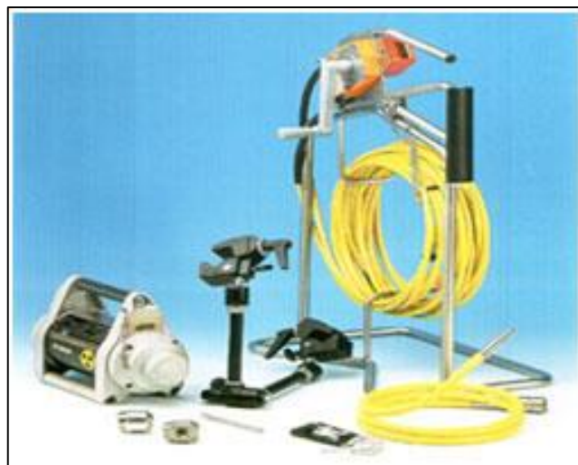
Figura 28-Equipamento utilizado em um teste de gamagrafia industrial.
