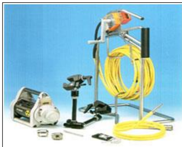
Figura 81-Equipamento utilizado em um teste de gamagrafia industrial.
