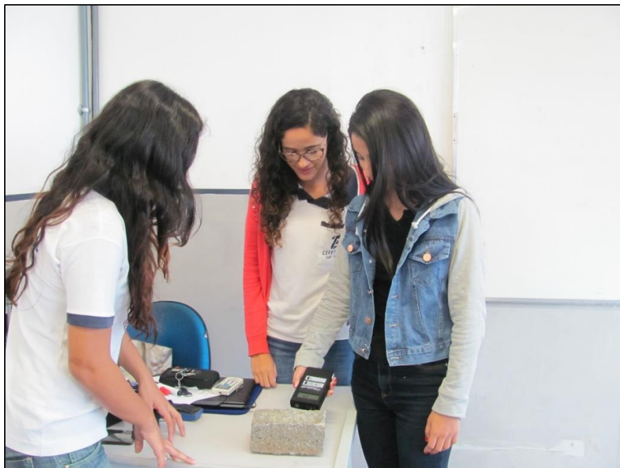
Figura 35- Alunas realizando a medição da radiação proveniente de um bloco de concreto.
