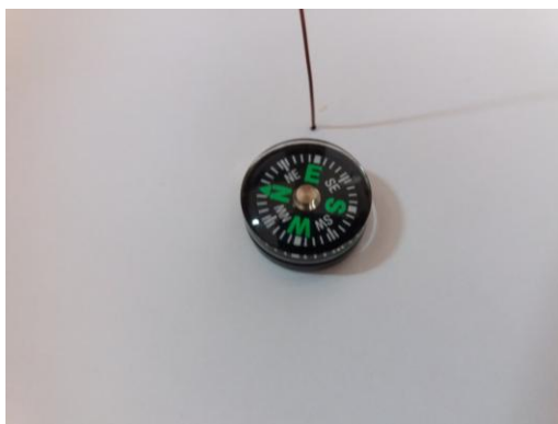
Figura 2.6. Bússola nas vizinhanças do fio condutor com corrente elétrica 7 .
