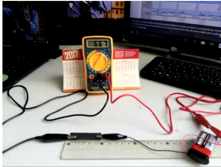
Figura 6. – Circuito elétrico da primeira atividade: Bateria, amperímetro e resistor em série. As nossas fitas, com diferentes comprimentos L e diferentes larguras W representam o resistor ôhmico.
