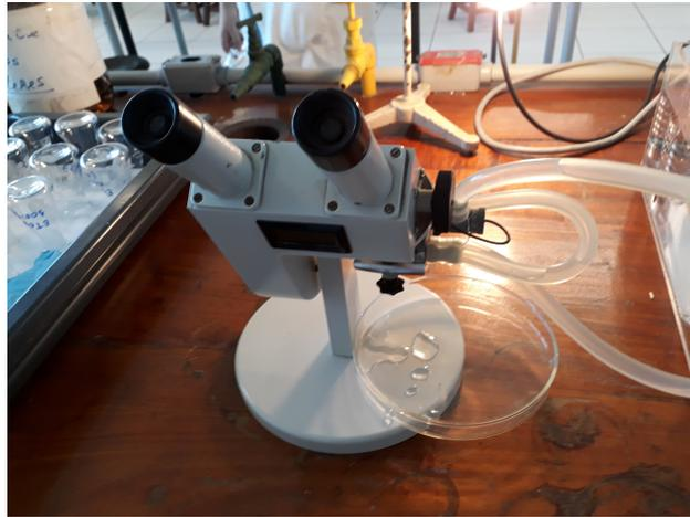
Figura 4.4: Refratômetro de Abbe utilizado para as medidas.
