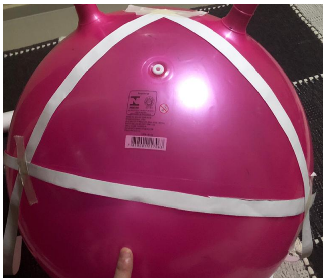
Figura D.3: Um triângulo feito com três tiras de papel presos com durex na superfície de um balão esférico. Removendo cuidadosamente o triângulo e medindo seus ângulos internos confirmará que a soma será maior que 180^\circ .
