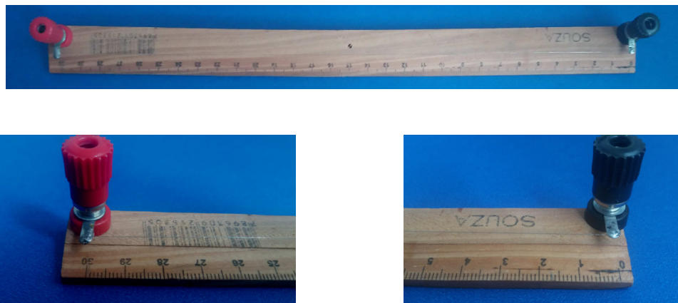
Figura 4: Resistor variável com fio de níquel cromo.
