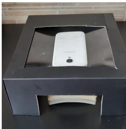
Figura 11: Aparato experimental utilizado para medir a variação de brilho no conjunto de lâminas.
