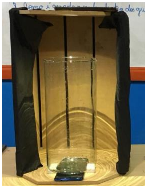
Figura 4.5: Aparato experimental utilizado para a verificação da Lei de Lambert-Beer.
