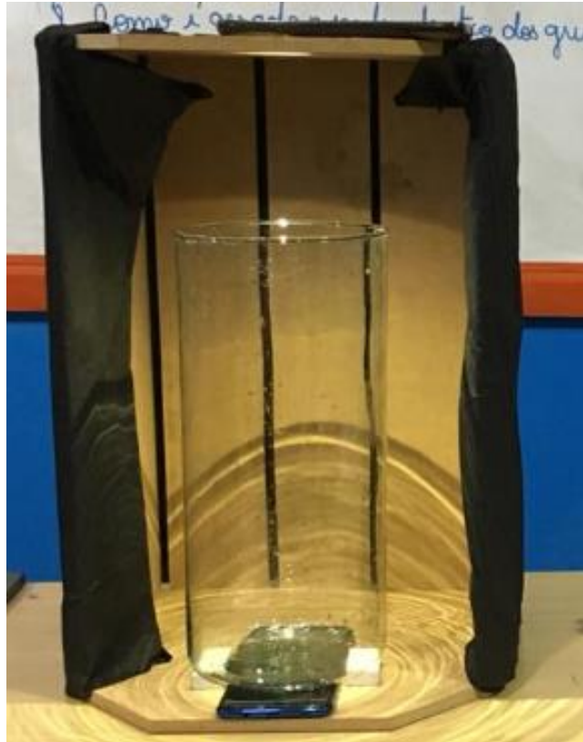
Figura 1: Aparato experimental utilizado para a verificação da Lei de Lambert-Beer.
