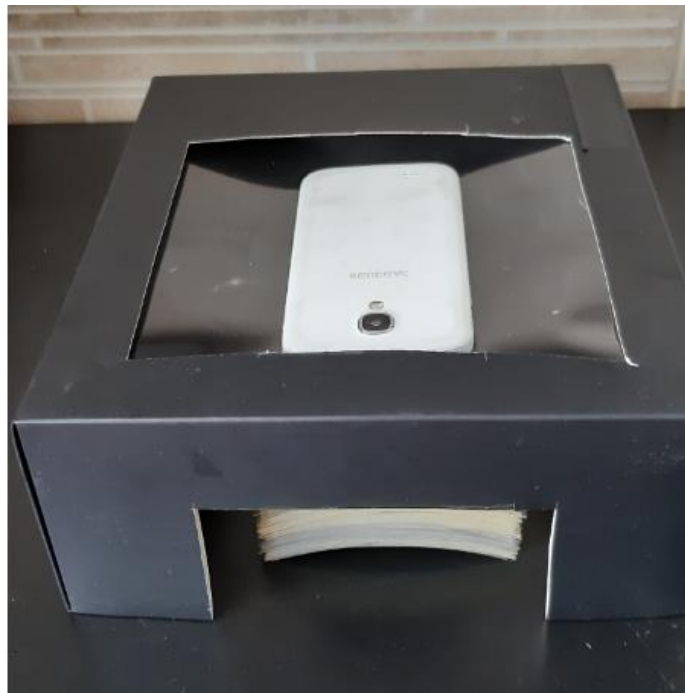
Figura 4: medidor da intensidade luminosa de placas transparentes.
