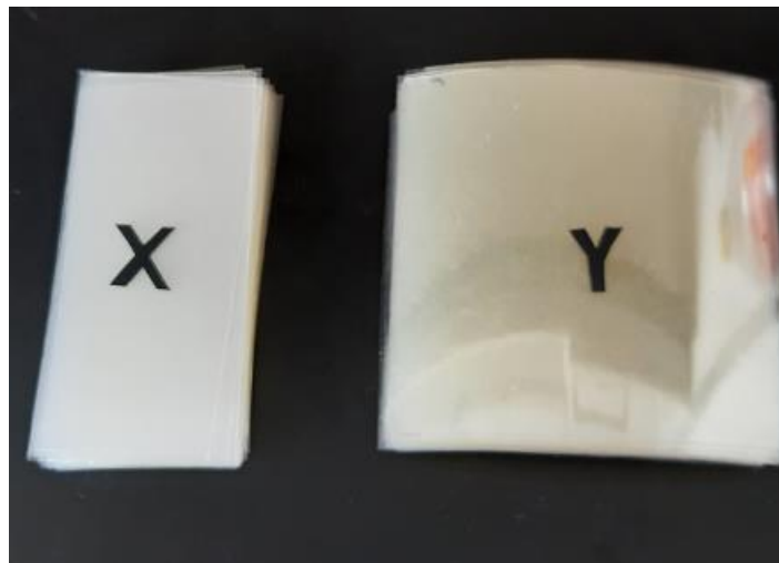
Figura 4.15: Pilha X, transparências usadas em retroprojeto, um dos lados da lâmina possui uma porosidade perceptível. Pilha Y, agrupamento de acetato, superfícies idênticas em ambos os lados. Uma e outra possuem a mesma quantidade de placas.
