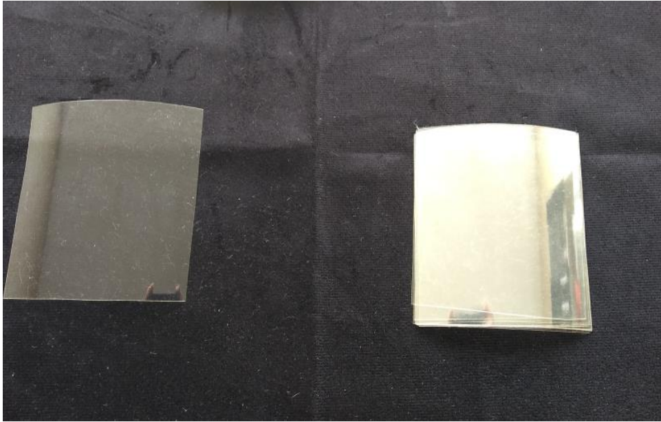
Figura 9.a: brilho de uma placa transparente versus brilho de 10 placas transparentes sobrepostas. As placas são idênticas.
