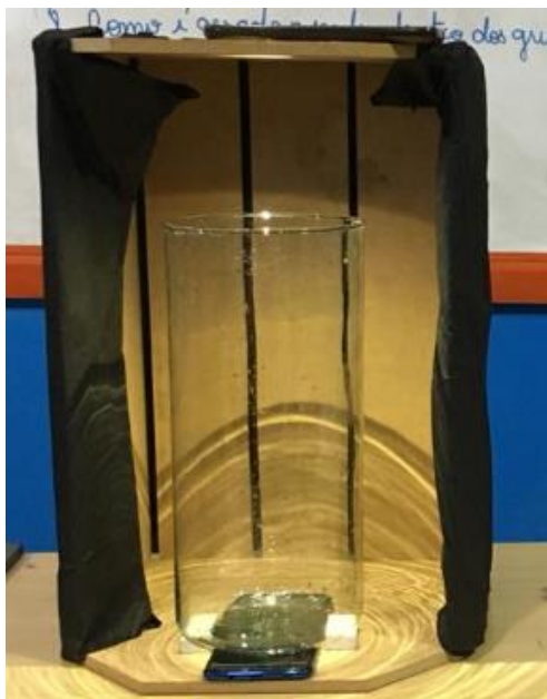
Figura 6: Aparato experimental utilizado para a verificação da Lei de Lambert-Beer.
