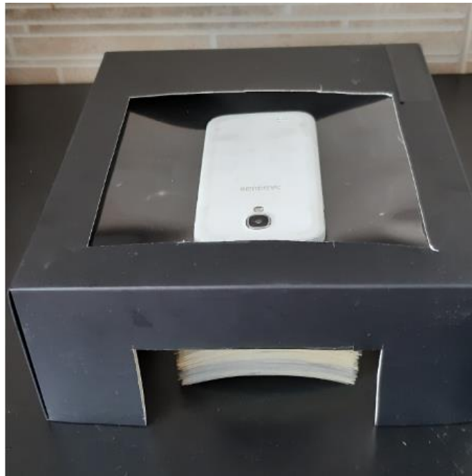
Figura 4.14: Aparato experimental utilizado para medir a variação de brilho no conjunto de lâminas.
