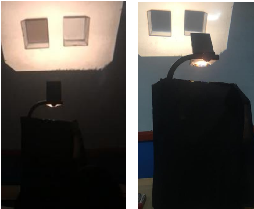
Figura 5.3: Projeção de dois recipientes idênticos, um contendo mistura de água e tinta branca e outro água e tinta preta. Na imagem da esquerda as tintas são diluídas em 500 mL de água. Na direita uma gota de cada tinta em 20 mL de água.
