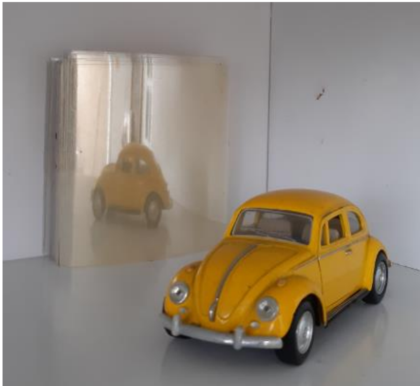
Figura 4.13: Refletividade de uma pilha de placa paralelas. Resultado que se aproxima de um espelho.
