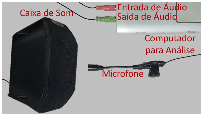
Figura 4.3: Disposição real dos equipamentos nas duas primeiras atividades.
