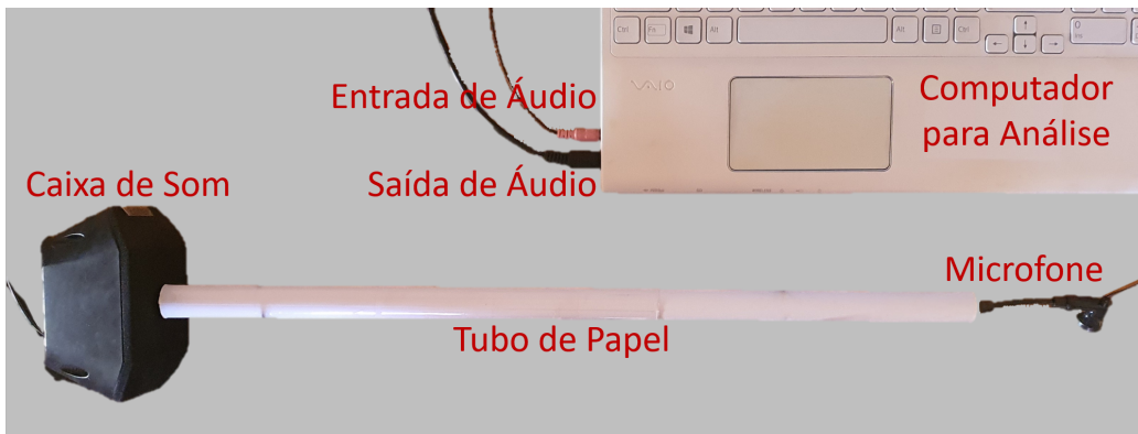
Figura 4.1: Disposição real dos equipamentos.
