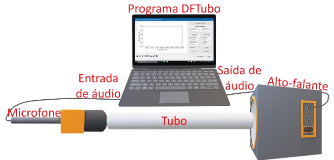
Figura 2 Disposição dos equipamentos na atividade 3.
