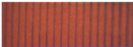
Figura 2.2: Padrão de interferência de luz vermelha [3].
