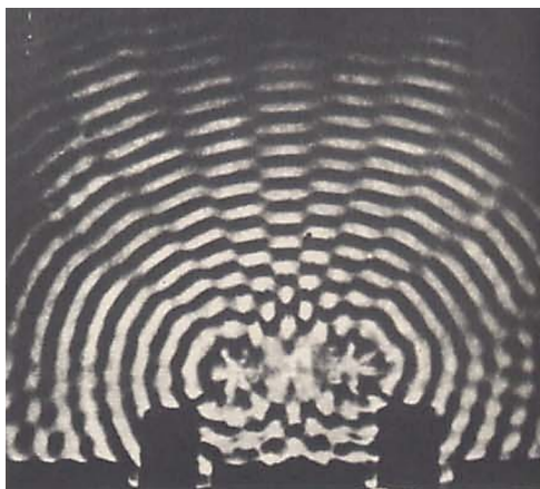
Figura 2.1: Padrão de interferência na cuba de ondas [3].
