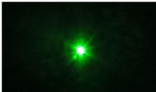
Figura 3: A luz emitida pelo laser, sem o fio de cabelo, atinge apenas um local no anteparo.
