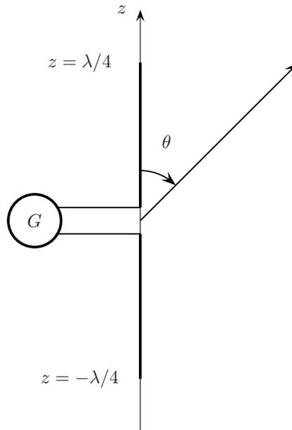
Figura 6: Geometria da antena de meia onda.
