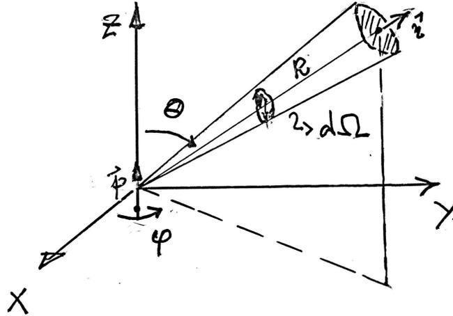
Figura 2: Geometria do cálculo da radiação de um dipolo elétrico ideal.
