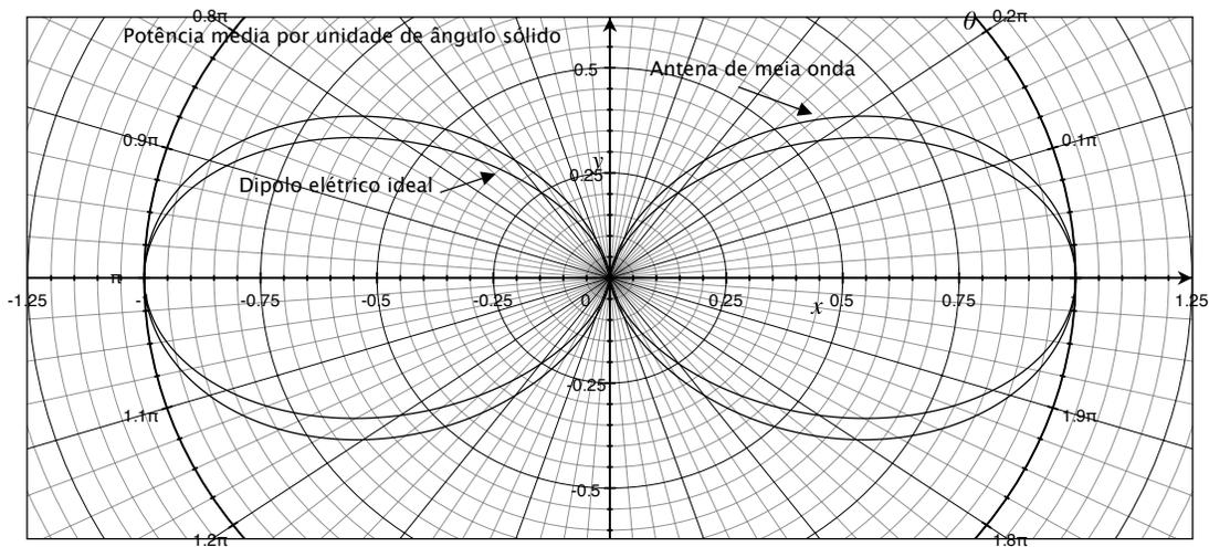
Figura 7: Distribuição angular da radiação de dipolo e de antena de meia onda.
