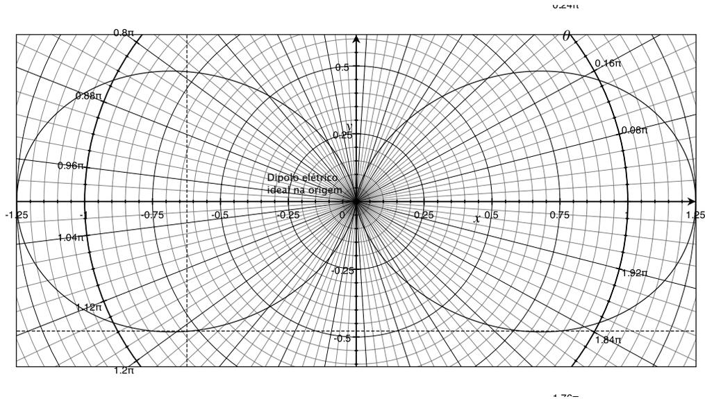
Figura 3: Distribuição angular da radiação de um dipolo elétrico ideal.
